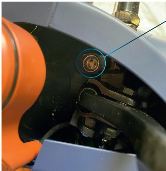
Le contrôle du niveau de liquide de frein au guidon, côté gauche et droit, doit être effectué sur sol plan horizontal et guidon droit. Il concerne le levier droit et gauche au guidon.
