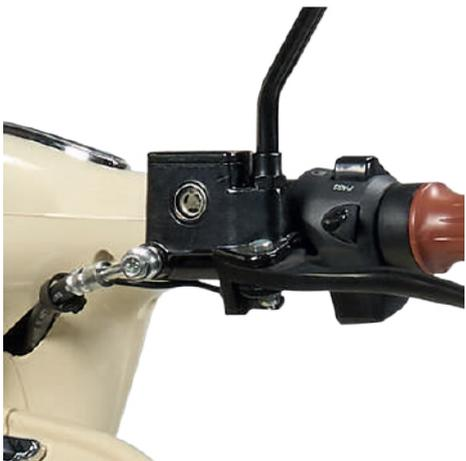
Le contrôle du niveau de liquide de frein au guidon, côté gauche et droit, doit être effectué sur sol plan horizontal et guidon droit. Il concerne le levier droit et gauche au guidon.
