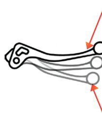
2- en pressant plus fort, un freinage hydraulique vient renforcer cette action.
