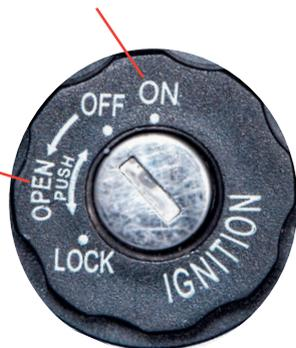
Verrouillage de la colonne de direction
