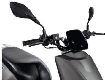
Serrer le frein droit pour actionner le frein avant. La commande est hydraulique.
