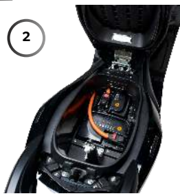
Déverrouillez la barre de maintien en position, puis basculez-la à la verticale,
