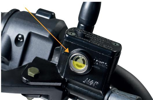
Le contrôle du niveau de liquide de frein au guidon, côté gauche et droit, doit être effectué sur sol plan horizontal et guidon droit. Il concerne les leviers droit et gauche du guidon. En aucun cas, le niveau ne doit être inférieur au centre du regard.
